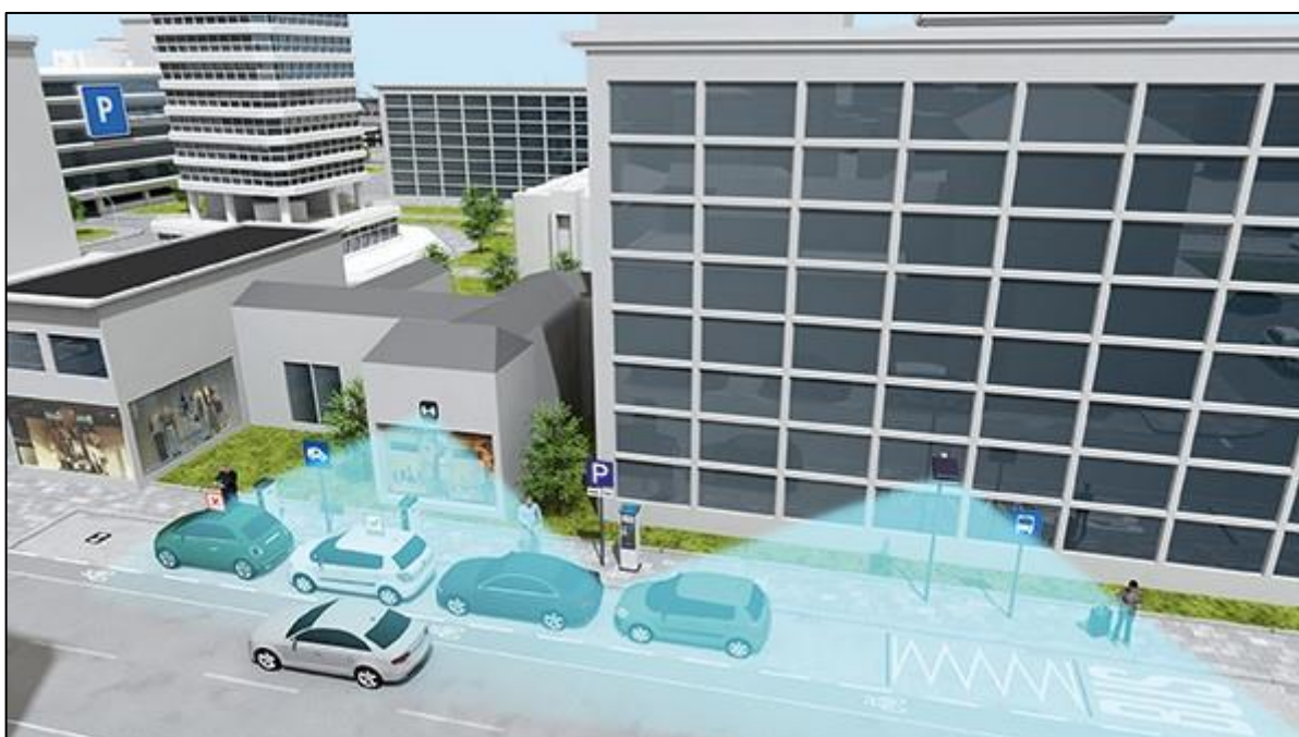
Detecția ocupării locului de parcare
